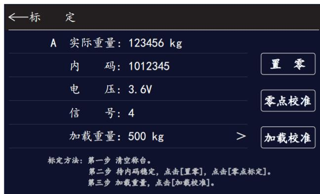
具体标定方法可根据仪表界面上的提示进行操作。在轴重台板标定前，用户需先提前清空秤台，并将秤体放置在水平硬质地面上。待仪上显示的台板内码稳定后，点击“置零”，再点击“零点标定”，点击页面左侧的“加载重量”，输入秤体标定时所加载的砝码重量，待砝码压在台板上后点击“加载校准”，确定加载重量，此时标定流程结束。
